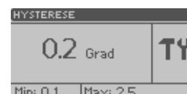
durch häufiges öffnen von Außentüren/Fenstern o.ä.) kann die Empfindlichkeit auf z.B. 1°C eingestellt werden, was bedeutet, dass die Heizung abschaltet, wenn die Solltemperatur erreicht ist, sie aber erst wieder einschaltet, wenn die Temperatur um den eingestellten Hysterese-Wert (z.B. 1°C) gefallen ist. Die Hysterese kann im Bereich von 0,1 bis 2,5°C mit einer Genauigkeit von 0,1°C eingestellt werden.
